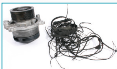
Überbelastung durch falsche Riemenspannung
