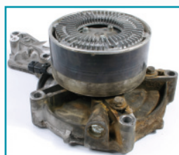
Lagerschaden durch Leckage
