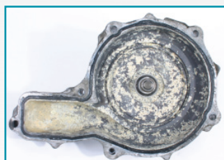
Kavitation durch falsches Kühlmittelverhältnis
