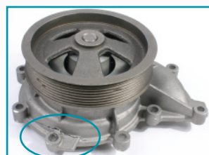
Rissbildung durch unsachgemäßen Einbau
