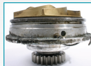
Defekte Gleitringdichtung durch unsachgemäße Verwendung von Dichtmittel
